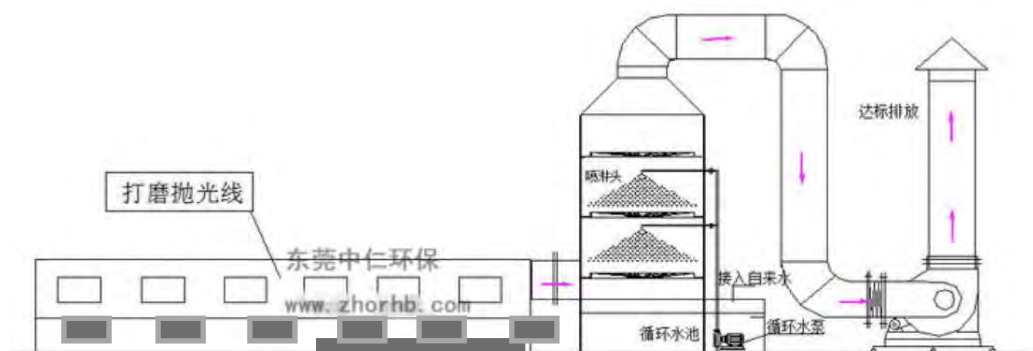
图 4.1-17 抛光粉尘处理工艺示意图
